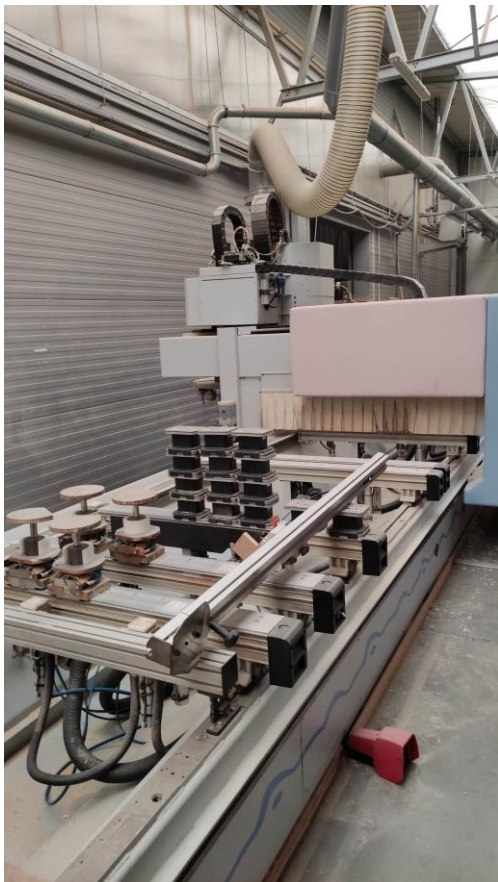
Fot. 12, 13, 14, 15. Elementy robocze maszyny wraz ze stołem i podstawkami pod materiał
