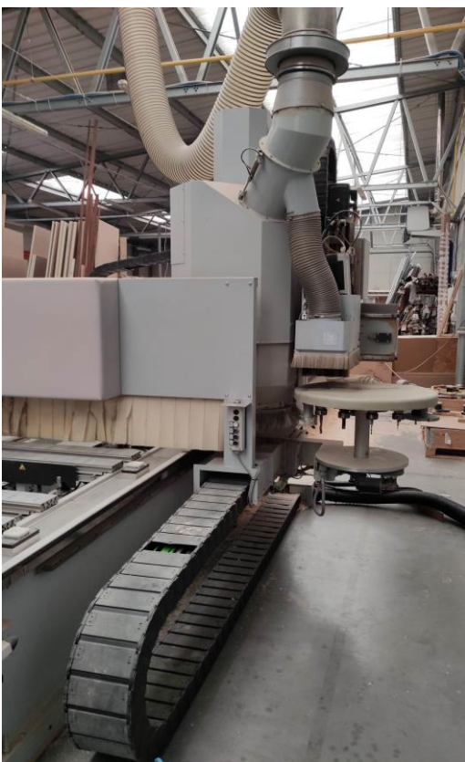
Fot. 8, 9, 10, 11. Elementy robocze maszyny wraz z elementami napędu i odciągami pyłu
